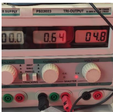
Consommation de courant lorsque 50 LEDs rouges sont allumées
